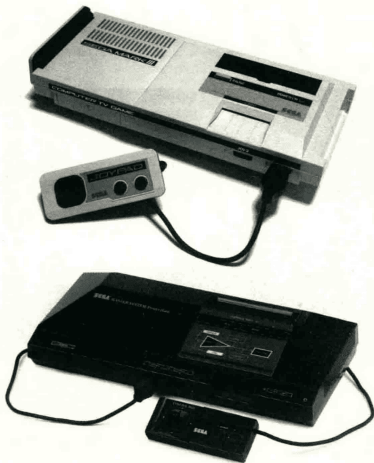
SEGA MarkIII (上) 和 SEGA Master System (下)。这两款产品均保持了对 SG-1000 以及后续机型的向下兼容性，以前推出的游戏都能在新机型上直接玩
