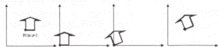
图 17-5 将房子平移到原点，然后旋转，再平移回原来的位置。这样的效果是房子绕自己的左下角旋转了
