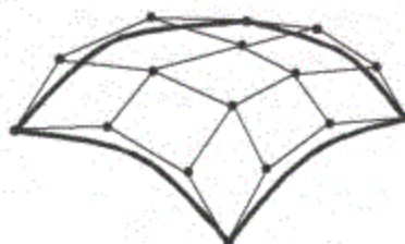
图 17-15 由 16 个控制点构成的 Bezier 曲面
