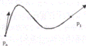
图 17-12 为了确定曲线段的参数，需要 P0 和 P1 的坐标，以及曲线段在 P0 和 P1 两处的斜率。共四组数据
