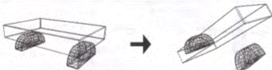
图 13-39 因为没有建立层次关系，在旋转桌子的时候出现的错误
