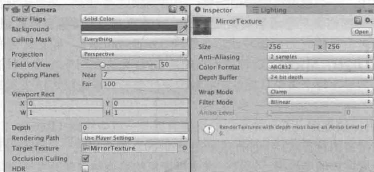
图 10.12 左图: 把摄像机的 `Target Texture` 设置成自定义的渲染纹理。右图: 渲染纹理使用的纹理设置
