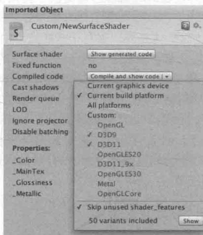
▲图 3.9 在 Unity Shader 的导入设置面板中可以通过 *Compile and show code* 按钮来查看 Unity 对 CG 片段编译后的代码。通过单击 *Compile and show code* 按钮右端的倒三角可以打开下拉菜单，在这个下拉菜单中可以选择编译的平台种类，如只为当前的显卡设备编译特定的汇编代码，或为所有的平台编译汇编代码，我们也可以自定义选择编译到哪些平台上。
