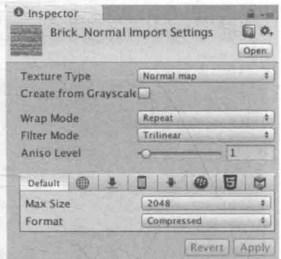
▲图 7.16 当使用 `UnpackNormal` 函数计算法线纹理中的法线方向时，需要把纹理类型标识为 Normal map
